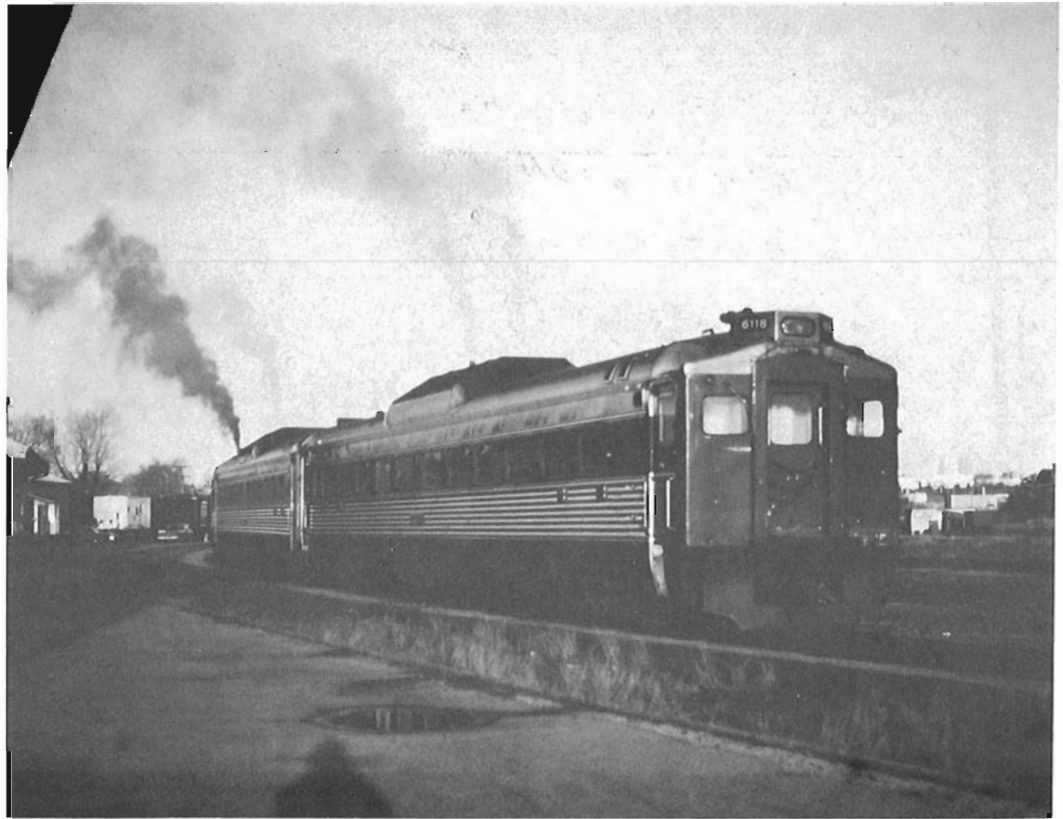
Le train #651 quitte la vieille gare du Grand Tronc de Kingston à 0640 le matin du 2 mai 1981. Il arrivera à la gare de VIA Rail vers 0655 et partira pour son périple vers Toronto à 0700. Ce matin-là, le train était constitué des autorails RDC1 #6118 (aux couleurs du CN), RDC2 #6005, et RDC2 #6204.
