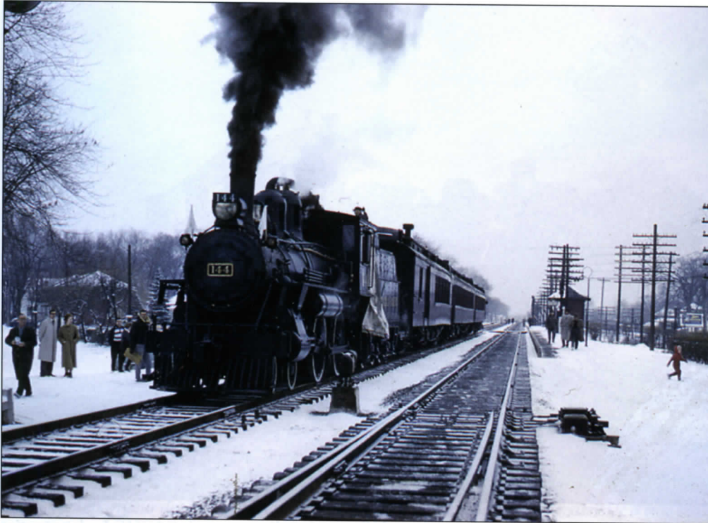
22 novembre 1959. À Vaudreuil, Québec, le chauffeur, Philippe André, lâche la vapeur sur la No 144 du CP, une 4-4-0 en partance pour Soulanges, Qué., et Cornwall, Ont. La No 144 est la plus ancienne locomotive fabriquée au Canada encore existante. Elle est préservée à Exporail en compagnie de wagons passagers semblables à ceux qu'on voit sur la photo. Archives ACHF, Fonds Worthen.
