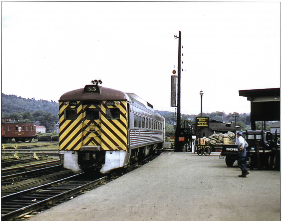
L'automotrice Budd No 9069 du CP. Elle se prépare à partir de la gare de White River Junction au Vermont. Elle fonctionnait comme le train No 332 du Boston & Maine (appelé L'Alouette) qui reliait Boston à Montréal en service de jour. On peut voir l'antique signal de type « à boules » qui fut utilisé jusqu'en 1957. Quand toutes les boules étaient en haut du signal, cela indiquait que la voie était libre. Photo : Ronald Ritchie No 2808.
