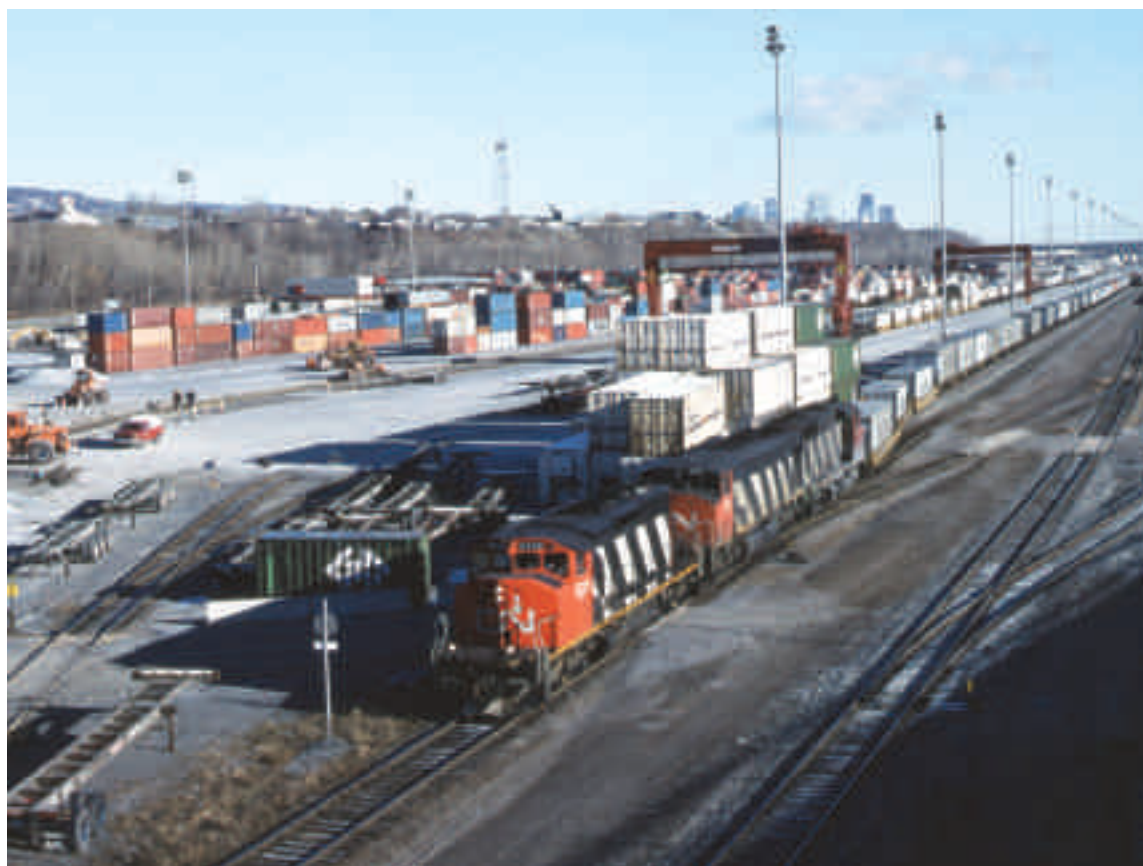
Plus récemment, en 1995, alors que la cour Turcot du CN servait surtout de terminal pour conteneurs, la 5335, une SD40-2 à cabine pleine largeur, la 2113, une rare HR-616, et une unité non identifiée sont en charge d'un train intermodal. En juin 2002, Turcot fut fermée en tant que terminal pour conteneurs et ses opérations furent transférées à la cour Taschereau. Ken Goslett
